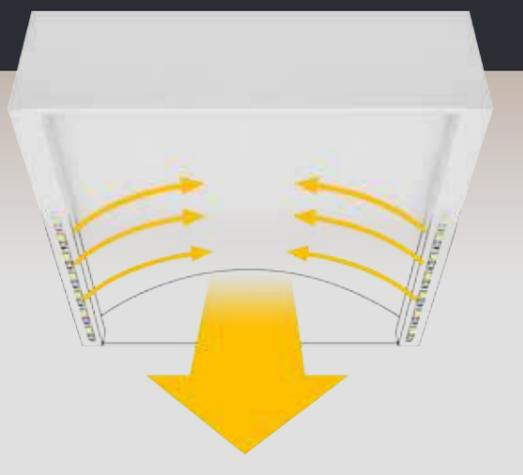
LEDS ILUMINAM O CENTRO CÔNCAVO DE FORMA INDIRETA, GERANDO CONFORTO VISUAL SEM OFUSCAMENTO
